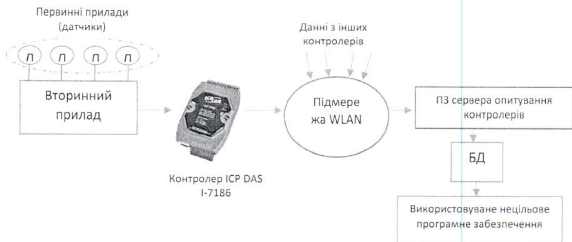
Малюнок 1. Структурна схема диспетчеризації
